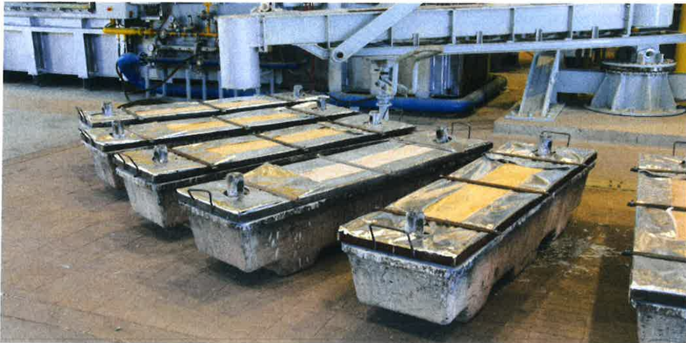
W nowej hali produkcji powstają dwutonowe cynkowe bloki. Fot. Archiwum HCM
